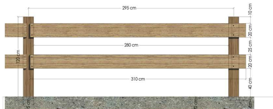
Prospetto della staccionata
